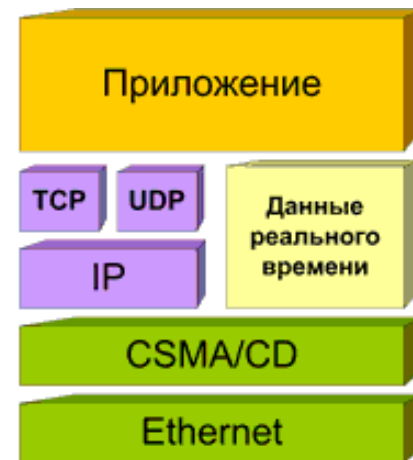
Структура PROFINET в уровнях модели OSI
